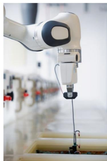
**Bild 1** > Modulare, prozessgesteuerte Galvanikanlage im 20 l-Maßstab mit integrierter Badanalyse und automatisierter Nachdosierung (links). Roboter-unterstützter Beschichtungsprozess (rechts).
